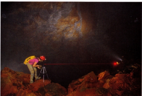
Photographie 12 : topographie au DistoX dans la salle du Brouillard. Cliché Jean-Michel Östermann, Laurence et Jean-Michel Salmou.
